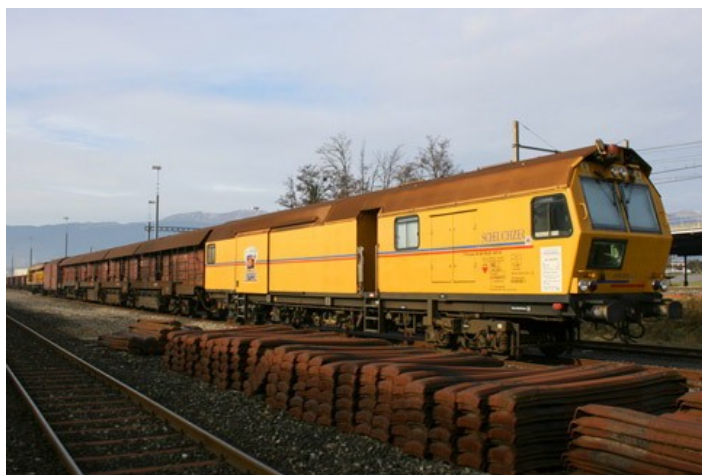
Train meuleur de rails (Scheuchzer S.A.)
