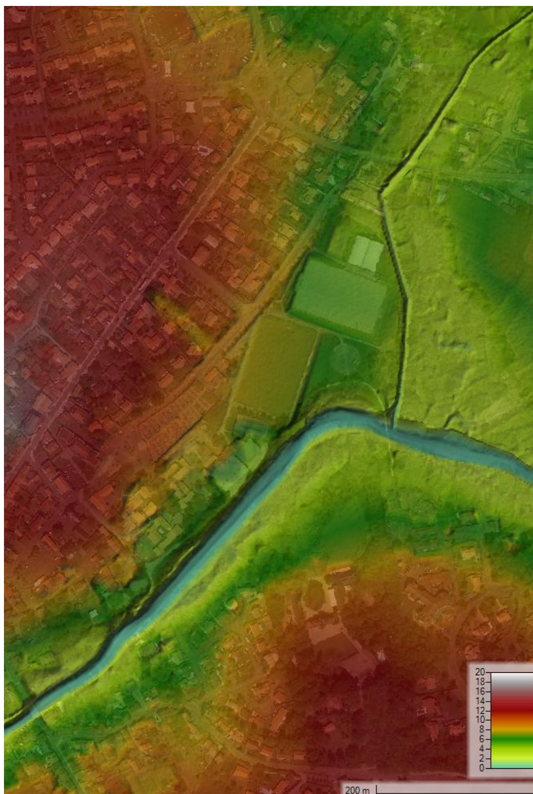
Figure 21 - Modèle Numérique de terrain créé pour la projection des résultats de modélisation hydraulique
